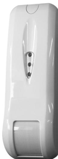
RFDT12CE est un détecteur sans fil à double technologie effet rideau, destiné à la protection de portes ou de murs à accès multiples. Avec une portée de 12 m et un effet rideau avec ouverture à 7,5°, il protège une zone bien délimitée qui peut être adaptée aux différents besoins grâce à l'étrier en « L » compris. Disponibilité d'étriers en option de 10 et 15 cm pour écarter le détecteur du mur.
