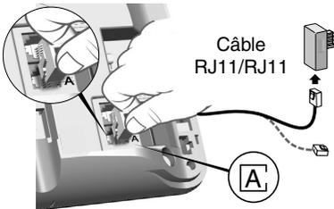
Raccordez le câble RJ11/RJ11 à la ligne téléphonique en intercalant l'adaptateur RJ11 convenant à votre installation.
