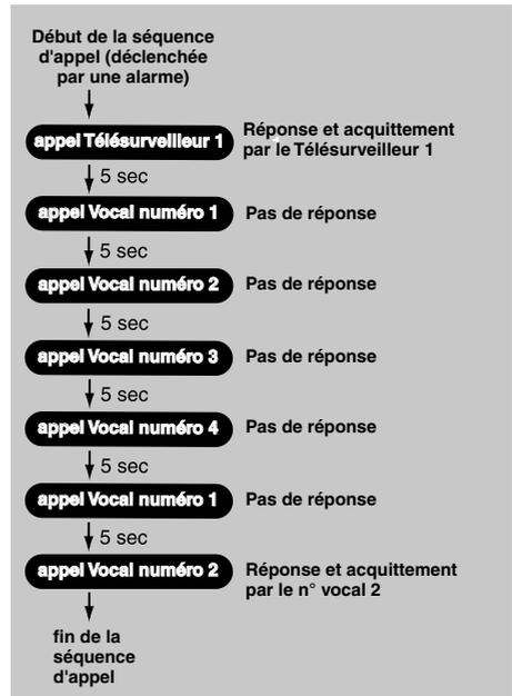
Selon le type de produit installé, vous pouvez utiliser trois protocoles au choix pour échanger diverses données avec le centre de télésurveillance (test cyclique, alarme...) :
