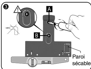
Fixez le support mural à l'aide de 2 vis  $\varnothing$  4 mm Max. en utilisant les trous A et B. **N'utilisez pas de visseuse pour visser la vis repérée B.**
