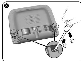
À l'aide d'un tournevis, soulevez les 2 clips maintenant le capot supérieur.
