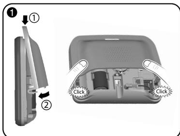
Remplacez le capot supérieur et clipsez-le sur le boîtier.
