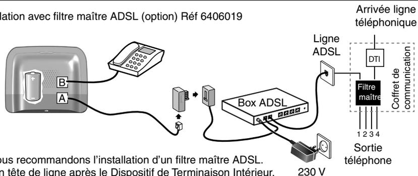
Nous vous recommandons l'installation d'un filtre maître ADSL. Placé en tête de ligne après le Dispositif de Terminaison Interieur, cet appareil atténue fortement les perturbations électromagnétiques en séparant le signal ADSL de la ligne téléphonique. Il améliore la cohabitation des différents appareils connectés sur votre installation téléphonique.
